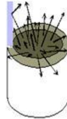
Emisión fotónica en diodo LED
